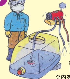
(洗浄終了後タンクのドレンを開け、タンク内を流水で洗浄する)
